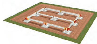
L'utilisation de ce système de soubassement facilite également la réalisation de vide sanitaire en mitoyenneté. Différents modèles de plots sont proposés selon la nature du sol et le dimensionnement du projet. Par ailleurs, la ventilation du vide sanitaire est assurée par des ouvertures prévues à cet effet.
