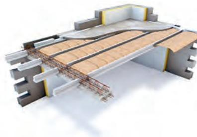
Figure 39. Illustration des déperditions des ponts thermiques et efficacité des rupteurs de ponts thermiques (© FIB).
